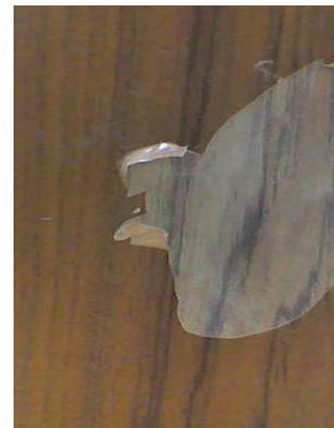
Sul legno di teak è necessario un ciclo speciale per evitare distacchi del film di verniciatura e difetti nella fase di essiccazione
